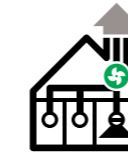
HUIPPUMURI/ POISTO USEISTA TILOISTA
