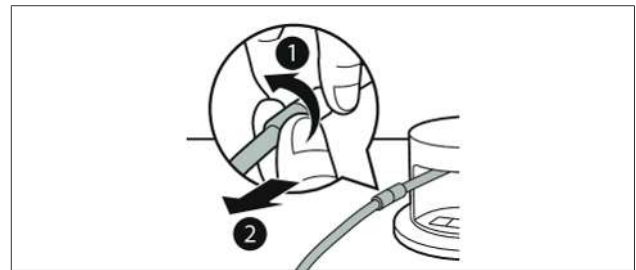
Kuva 6.3 Tyhjiöintiletkun irrottaminen liitoksesta
