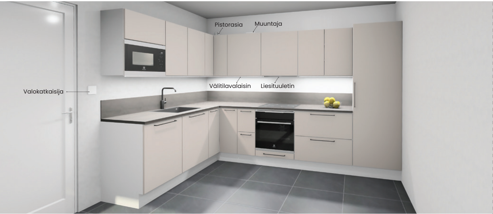
Kuvan esimerkissä 5000 mm valonauha on katkaistu ensin kulman vuoksi. Virtajohdot kulmasta ylös jakajamoduuliin. Liesituulettimen vuoksi valonauha joudutaan katkaisemaan uudelleen, joten joudutaan käyttämään yhdysjohtoa 80494.
